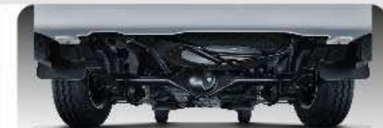
Hệ thống truyền động đồng bộ giữa động cơ - hộp số - cầu chủ động kết hợp với tỉ số truyền tối ưu giúp TERA-V8 tiết kiệm nhiên liệu hàng đầu phân khúc.
